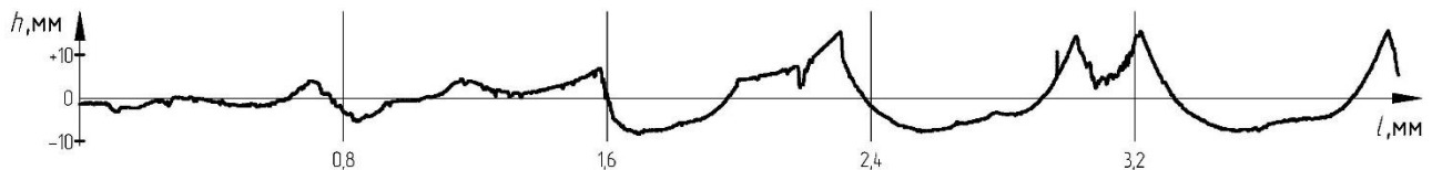
Рис. 8 Продольная профилограмма очага деформации, возникающего на рабочем конусе деформирующей фильеры при волочении сплошной цилиндрической заготовки со сложно модифицированным поверхностным слоем
