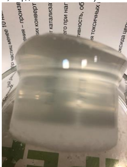
Рис.1 Фотография монолитного образца ксерогеля (полимерного стекла) состава 3SiO_2 \cdot 1,5Al_2O_3 \cdot nH_2O .
