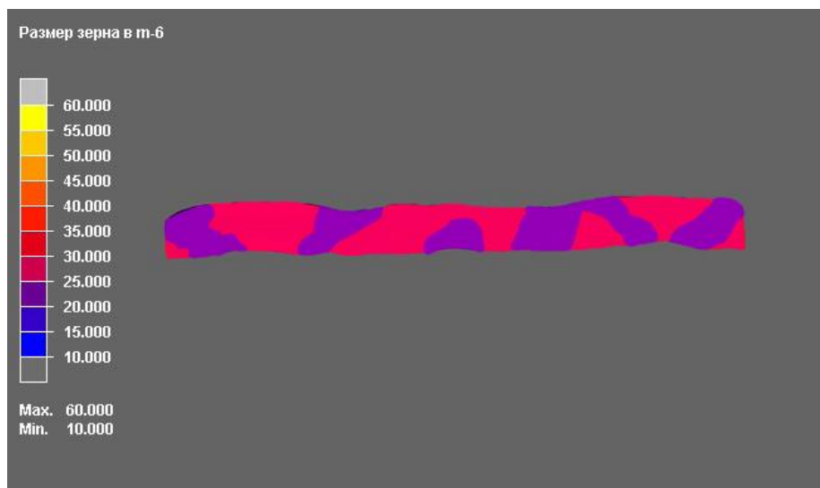
Рис. 3. Изменение микроструктуры по ходу прокатки: а – исходная заготовка; б – заготовка после прокатки в рельефных валках; в – заготовка после второго прохода (гладкая бочка); г – заготовка после третьего прохода (гладкая бочка.)
