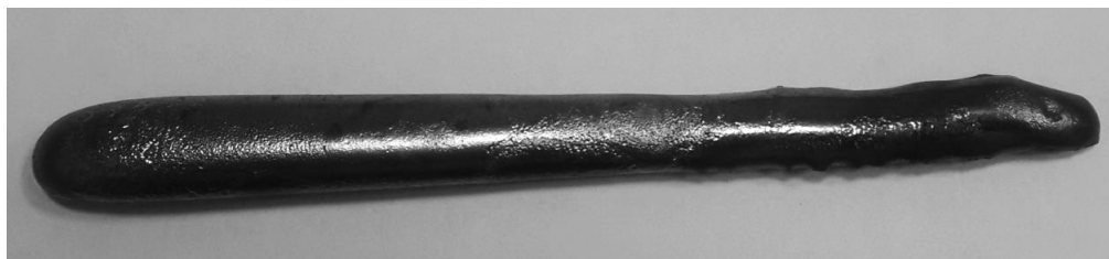
Рис. 1 Слиток сплава Ti-Ni-Hf с 5 вес. % Hf после выплавки в электронно-лучевой печи
