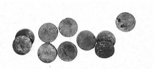
Рис. 2 Внешний вид обожженных таблеток экспериментальной смеси красного шлама БАЗ с добавкой 13,65 % \text{Na}_2\text{SO}_4
