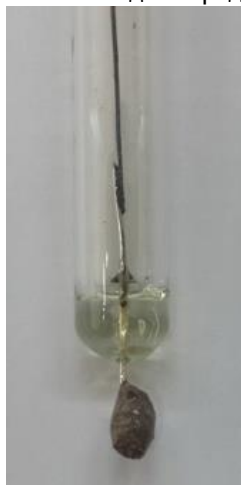
Рис. 2 Вид хлорсеребряного электрода применяемого в составе ГЭТ 54-2019
